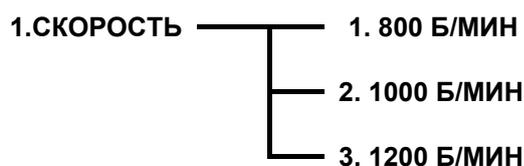
SB-2000 может работать на трех скоростях; 800 / 1000 / 1200 Б/МИН (банкнот в минуту). В подменю нажмите цифровую клавишу для выбора скорости. Также скорость можно выбрать клавишами прокрутки «л v» и СТАРТ). В режиме простого пересчета «СЧЕТ» можно устанавливать скорость до 1200 банкнот в минуту, но в режимах «НОМИН» (один номинал) или «МИКС» (смешанная пачка) максимальная скорость – 1000 банкнот в минуту. В нижеприведенной таблице указана максимально допустимая скорость для каждого режима.
